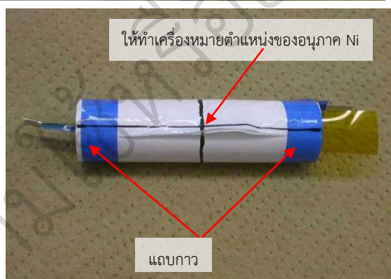
รูปที่ ก.6 การแยกส่วนประกอบของเซลล์ทรงกระบอก
